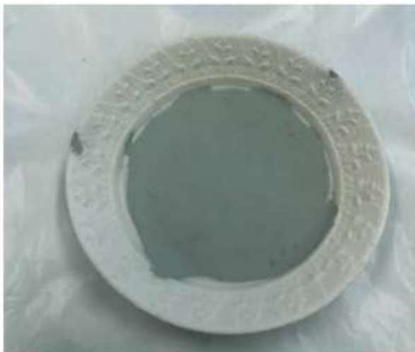
Abb.205: 3D-Druck des digital ergänzten Untertellers (W2) aus PLA mit Modelliermasse
