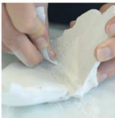
Abb. 197: Nachbearbeitung der Gipsform
