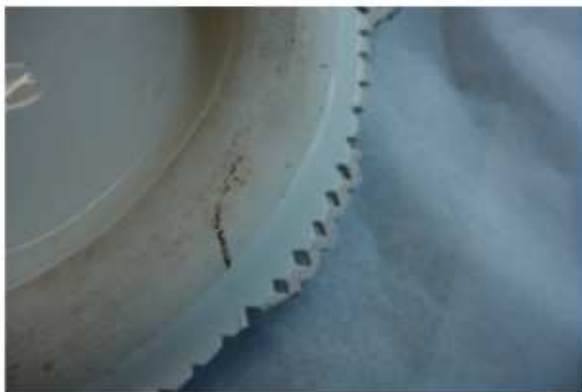
Abb.113: Abrieb Objekt A4
