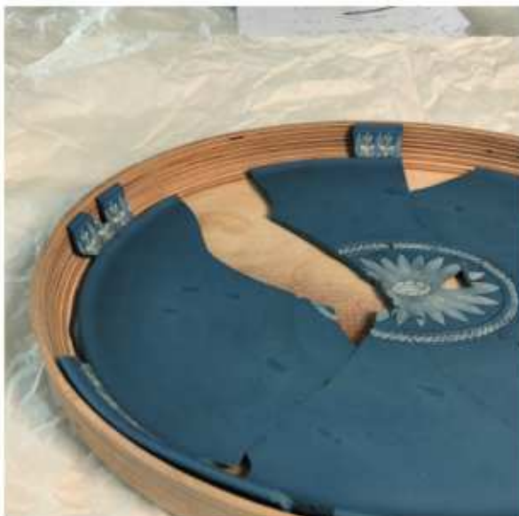
Abb. 188: Stützkonstruktion W1 aus Sperrholz
