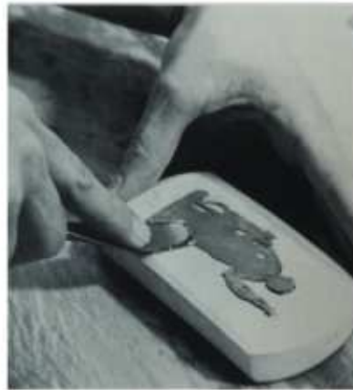
Abb. 106: Ausfüllen der Gipsform
