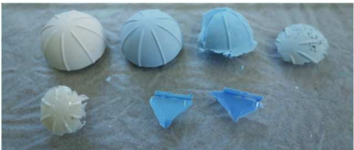
Abb. 154: Tests der verschiedenen Ergänzungsmassen, hintere Reihe Acrystal und Alabaster-Gips (ganz rechts), vordere Reihe HXTAL NYL-1
