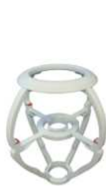
Abb. 148: Stützkonstruktion aus 3D-Druck PLA
