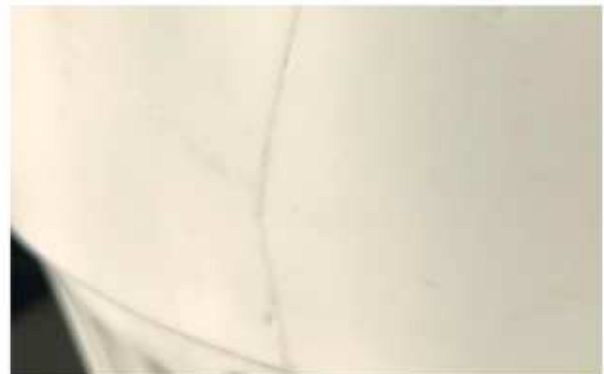
Abb. 153: Verkittung von Bruchkanten mit Paraloid B-72
