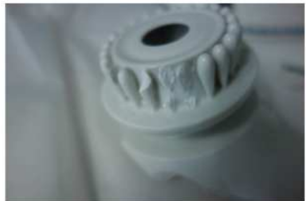
Abb.114: Absplitterung Objekt A7
