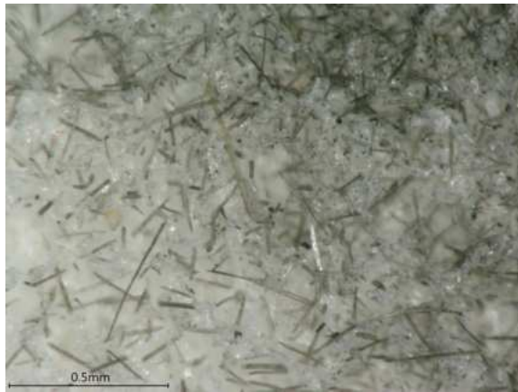
Abbildung 65: Aufnahme des PU-Schwamms unter dem 3D-Mikroskop: verschmutzte Faserreste sowie schwarze Pünktchen, vermutlich Staub- und Rußpartikel
