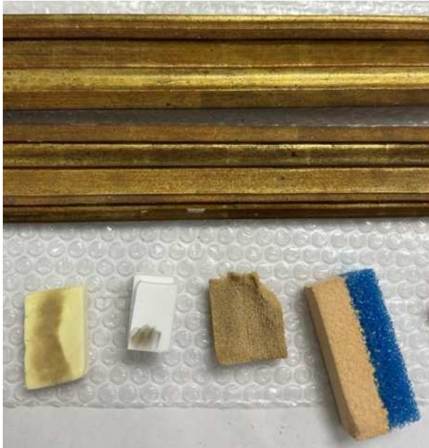
Abbildung 92: Testversuche zur Trockenreinigung der Zierleisten mit Schwämmen (von links nach rechts): Blitzfix®-Schwamm, PU-Schwamm, Latexschwamm und Wischab®-Schwamm
