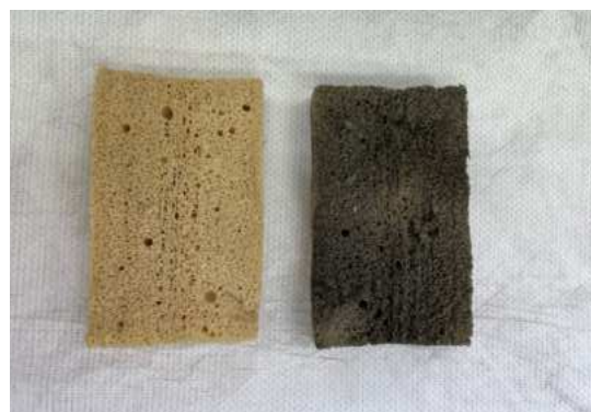
Abbildung 117: Latexschwamm vor (links) und nach (rechts) seinem Einsatz
