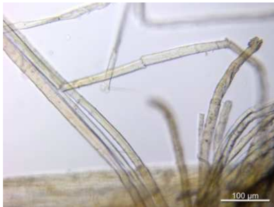
Abbildung 49: Leinenfaser unter dem Mikroskop
