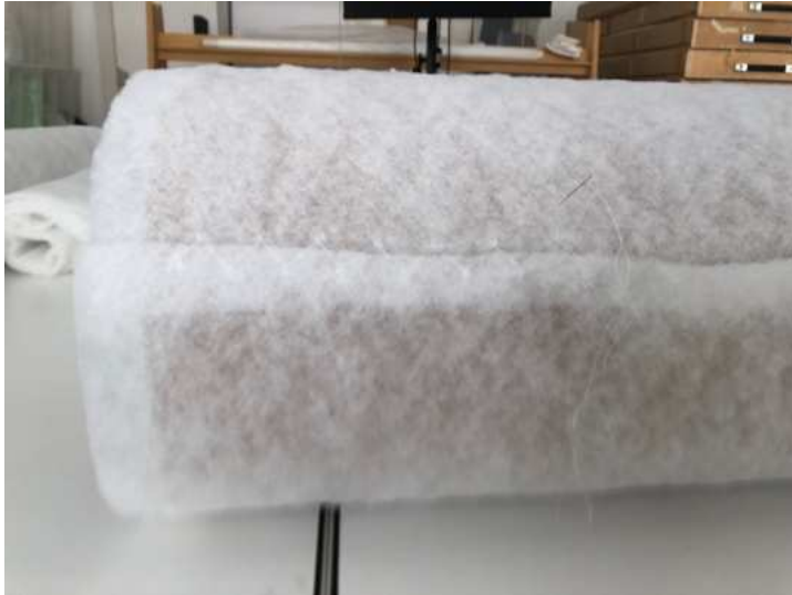
Abbildung 101: Vorbereitung der Rolle mit Hexenstichen an der ersten Schicht Acrylwatte
