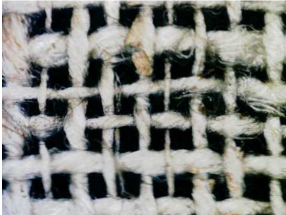
Abb. 8: Gewebe aus Leinen in Leinwandbindung
