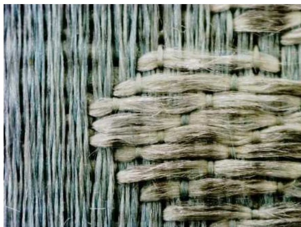
Abb. 3: Oberseite, Kettatlas mit Lancierschuss
