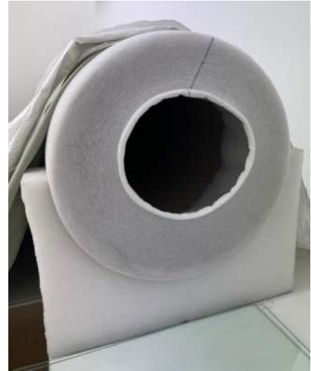
Abbildung 102: Ethafoam®-Halterung der Rolle für Transport und Bearbeitung
