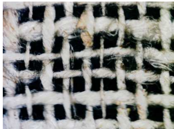
Abbildung 50: SZ/OW/WF1: Vergrößerte Aufnahme des Leinengewebes
