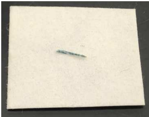
Abbildung 93: Ergebnis des Farbechtheitstest: der Farbstoff hat nicht ausgeblutet
