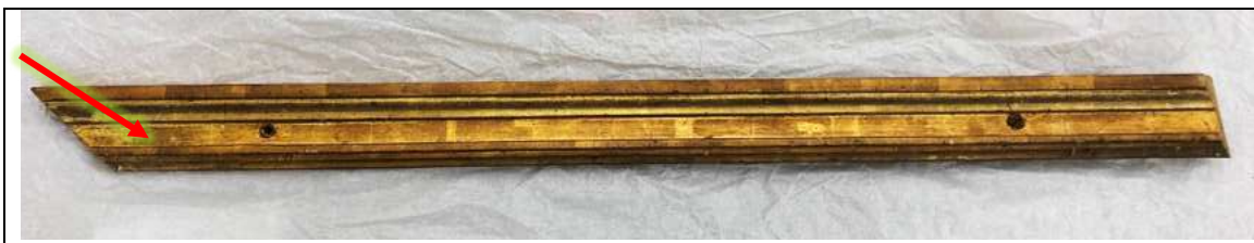
SZ/WW/WF1: Messpunkt der RFA Messung an der Zierleiste der Musterfläche
