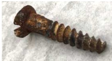
Abbildung 26: Eisenschraube zur Fixierung der Zierleiste
