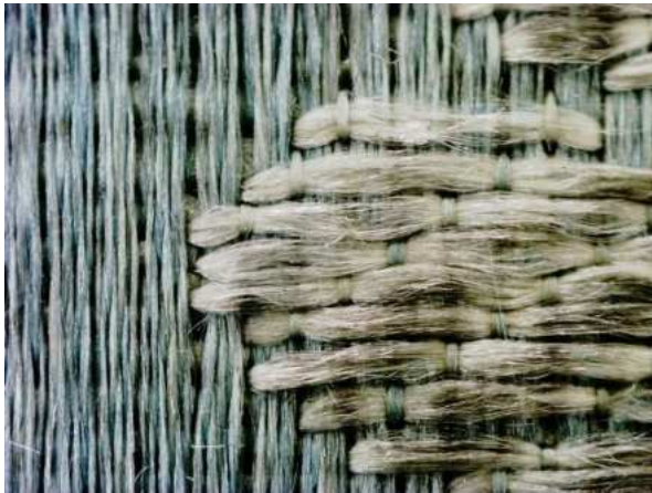
Abbildung 36: Kettatlas mit Lancierschuss an der Gewebeoberseite
