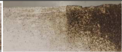
Abb. 120 Testfläche Oberflächenreinigung, Fliegenexkrement, weißer Bereich, nachher, Partielle Reinigung
