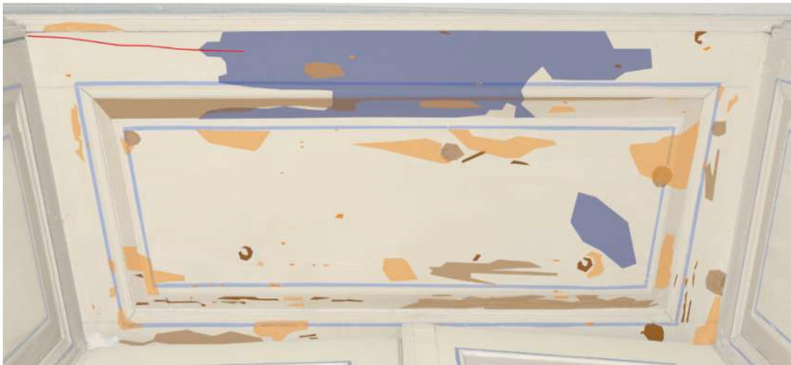
Abb. 203 Kartierung: Jagdspeisezimmer, Fenster, Sturz
