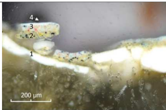
Querschliff/Malschichtaufbau, polarisiertes Auflicht, Detail
